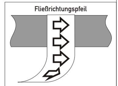
Eine deutliche Kennzeichnung der Rohrleitungen nach dem Durchflußstoff ist im Interesse der Sicherheit, der sachgerechten Instandsetzung und der wirksamen Brandbekämpfung unerlässlich. Sie soll auf Gefahren hinweisen um Unfälle und gesundheitliche Schäden zu vermeiden. Schilder oder Aufkleber sind an betriebswichtigen Punkten, z.B. Anfang, Ende, Abzweigungen, Wanddurchführungen, Armaturen, anzubringen. **(DIN 2403)**
